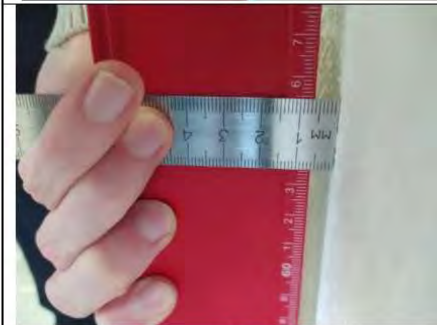
Фото №11. Измерения уровня стен в прихожей.
