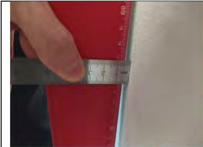
Фото №10. Измерения уровня стен в гостиной.
